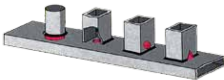
Fig.1: Gaten in het te verzinken materiaal _Les trous à prévoir dans les pièces à galvaniser
