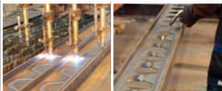
Fig. 1: Het productieproces van raat- en cellenliggers_Le processus de production des poutrelles alvéolaires et cellulaires
